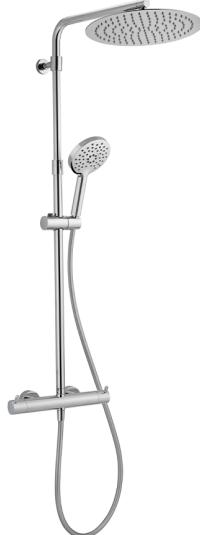
Colonna doccia termostatica 2 funzioni, deviastop 2 uscite, colonna telescopica, supporto doccetta scorrevole, doccetta 3 getti D.120 mm ABS, soffione tondo D.300 mm sp.2 mm in INOX, flessibile liscio SILVERFLEX 150 cm
