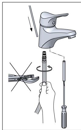
Avvitare al rubinetto i flessibili, evitando di serrarli con una coppia eccessiva. Avvitare il gambo di fissaggio - Inserire l'astina di comando. Fissare il miscelatore alla ceramica (spessore max 45mm) (dado esagonale chiave 11mm). Avvitare le calotte G.3/8" ai raccordi dell'impianto usando una chiave da 19mm. **IMPORTANTE:** evitare di fare presa sulla bussola del flessibile con chiavi esagonali o pinze regolabili che potrebbero compromettere la durata del flessibile stesso.
