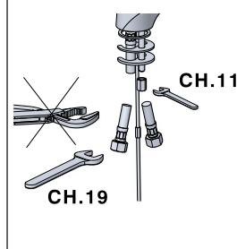
Atornillar los latiguillos al grifo, procurando NO apretarlos demasiado. Atornillen el vástago de fijación - Introduzcan la varilla de mando. Fijen el mezclador a la cerámica (espesor máximo 45mm) (Tuerca hexagonal llave 11mm) . Atornillar la tuercas G.3/8" a las conexiones de la planta hidráulica en las roscas específicas, utilizando una llave de 19mm. **IMPORTANTE:** no utilizar llaves hexagonales o alicates regulables en las roscas de los latiguillos, ya que pueden alterar su durabilidad
