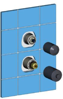
Togliere la protezione dall'adesivo posto sul retro della piastra e posizionare quest'ultima sul muro, facendola scorrere sul corpo.
