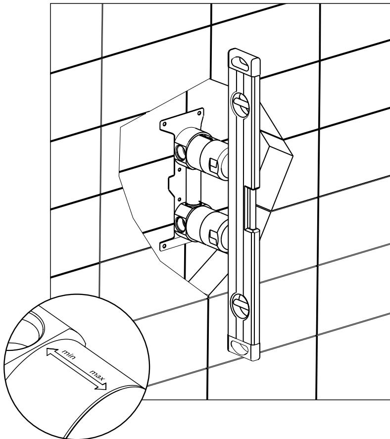
Con la ayuda de un nivel, posicionar correctamente el cuerpo a empotrar de manera horizontal y vertical siguiendo las indicaciones de las figuras a continuación prestando especial atención a la profundidad del empotrado mínimo y máximo indicada en las etiquetas ubicadas en la protección en plastica.
