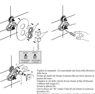
Pulire l'interno del corpo con un panno umido; sostituire la cartuccia facendo attenzione di inserirla nella sua sede in maniera corretta. Rimontare il tutto in ordine inverso ricordandosi di aprire le entrate delle acque (C).
