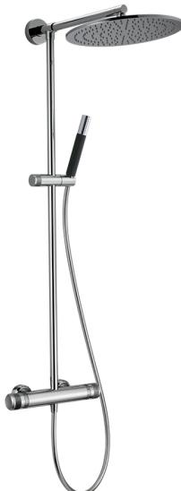
Colonna doccia termostatica 2 funzioni, deviastop 2 uscite, colonna fissa, supporto doccetta scorrevole, doccetta monogetto minimale D.24mm in Ottone, soffione tondo D.400 mm sp.8 mm in Ottone, flessibile liscio SUPREME 150 cm
