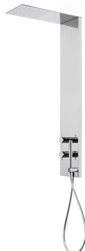
Pannello doccia monocomando 2 funzioni, pannello doccia in acciaio inox AISI 304, deviastop 2 uscite, supporto doccetta con presa d'acqua, doccetta monogetto D.23 mm ABS, soffione rettangolare 200x500 sp.24 mm Inox, con valvola di sicurezza brevettata, funzione pioggia, flessibile PVC 150 cm
