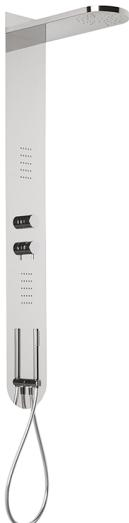
Pannello doccia monocomando 3 funzioni, pannello doccia in acciaio inox AISI 304, deviastop 3 uscite, supporto doccetta con presa d'acqua, doccetta monogetto D.23 mm in Ottone, 2 soffiocini frontal, soffione rettangolare stondato L.500 Ø100 sp.24mm, funzione pioggia, flessibile PVC 150 cm
