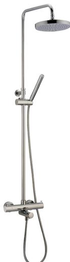
Colonna vasca termostatica 3 funzioni, deviastop 2 uscite, colonna telescopica, supporto doccetta scorrevole, doccetta monogetto minimalista in ABS D.26 mm, soffione tondo D.200 mm in ABS, flex Ottone 150 cm
